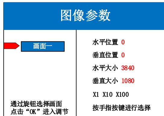
**第五步：**点击“MENU”，返回主菜单界面，进入菜单-高级-常用功能-局部显示（或使用前面板 FUNC 按键可快速进入常用功能，选择局部设置），进入局部显示设置界面，设置每个信号源的局部截取的大小以及位置。
