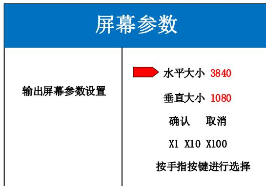
设置屏幕参数，设置水平大小和垂直大小为 LED 屏实际点数，点击“确认”完成参数设置
